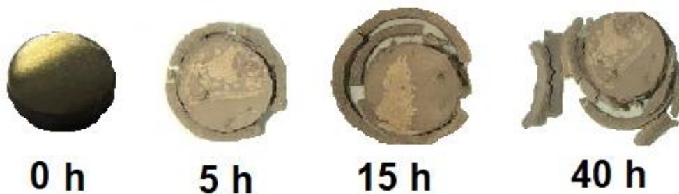
Figura 34 – Oxidação característica em função do tempo nos corpos de prova sinterizados das ligas M1 e M2. Fonte: autor.
