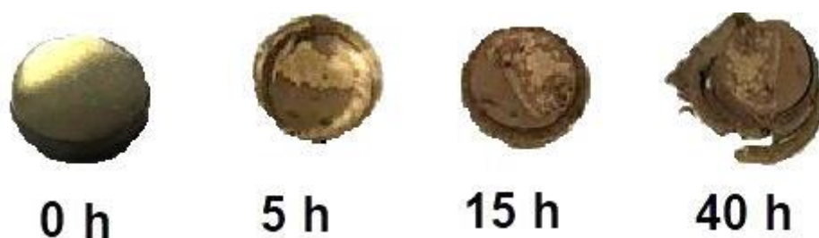
Figura 35 – Oxidação característica em função do tempo nos corpos de prova sinterizados das ligas M3. Fonte: autor.
