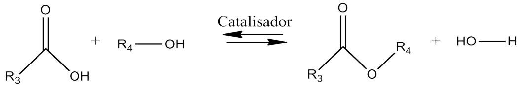
Figura 2: Esterificação de um ácido graxo com um álcool.
