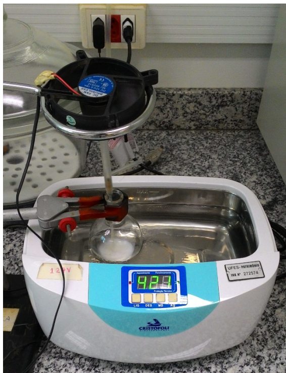
Figura 16: Sistema reacional com banho ultrassom e agitação mecânica.
