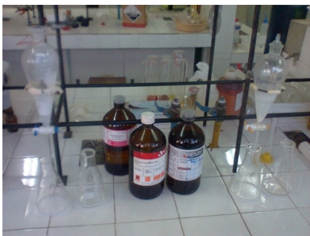
Figura 15: Extração múltipla por solvente (hexano).
