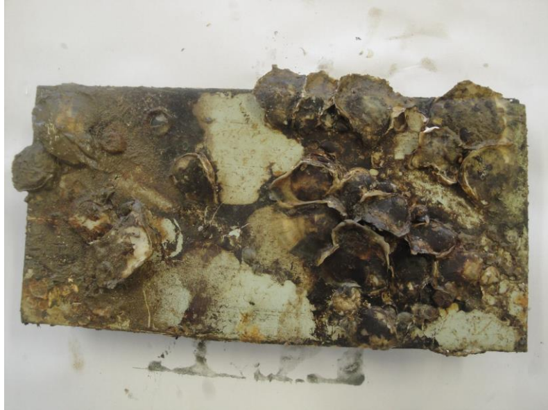
Figura 8. Detalhe das incrustações que aderiram ao amostrador após período de permanência em campo (Autor: GEMA).
