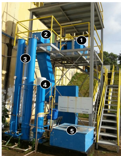
Figura 11 - Foto da Instalação Piloto - 1: Floculadores, 2: Decantador, 3: Filtros Rápidos, 4: Coluna de CAG e 5: Tanque de Contato
