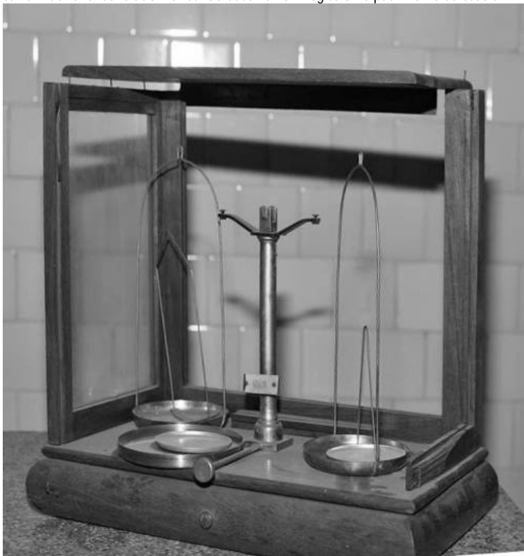
Figura 6 - Balança analítica (sem marca) sensível a 1 mg medindo 37.0 x 40.0 x 23.0 cm, com ausência de várias partes, inclusive o braço da balança e os vidros laterais da caixa. Não foi encontrado manual do usuário nem registro no patrimônio da escola.
