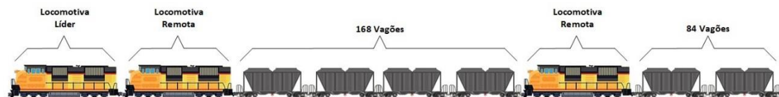
Figura 2.13 - Formação do trem para transporte de minério de ferro com 252 vagões
