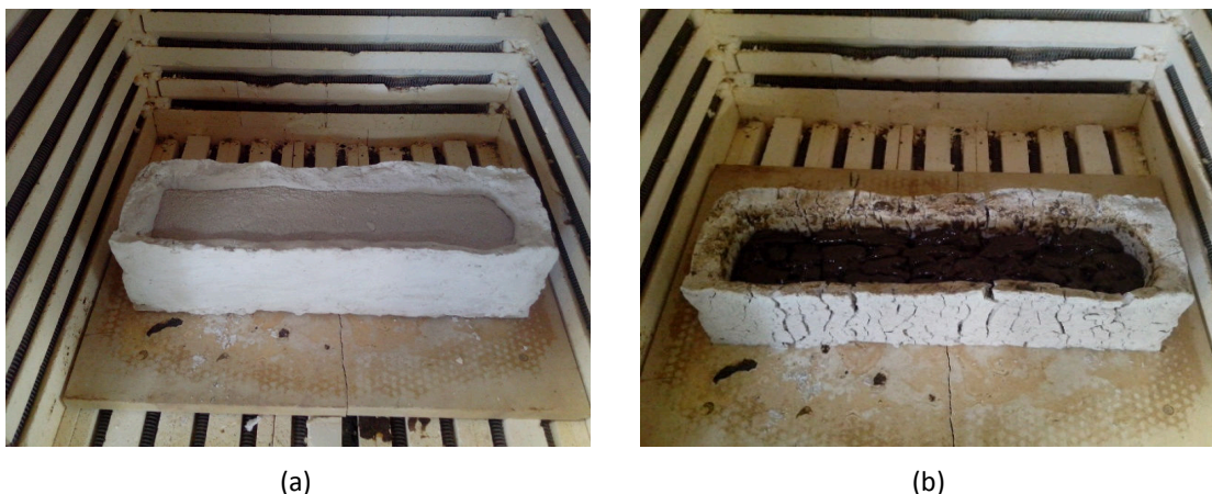
Figura 26: Recipiente de gesso com o resíduo (a) antes do tratamento térmico (b) depois do tratamento
