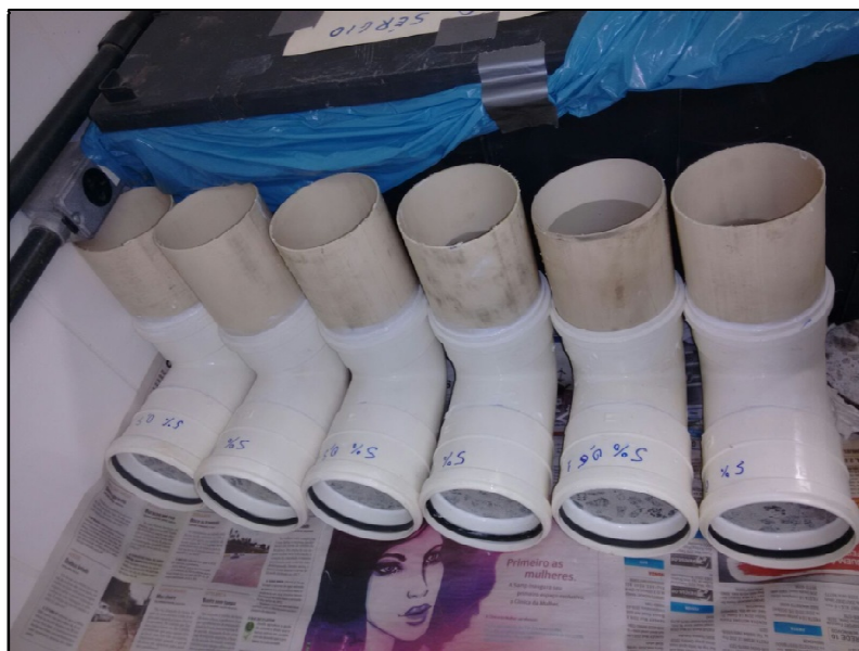
Figura 41: Teste de estanqueidade
