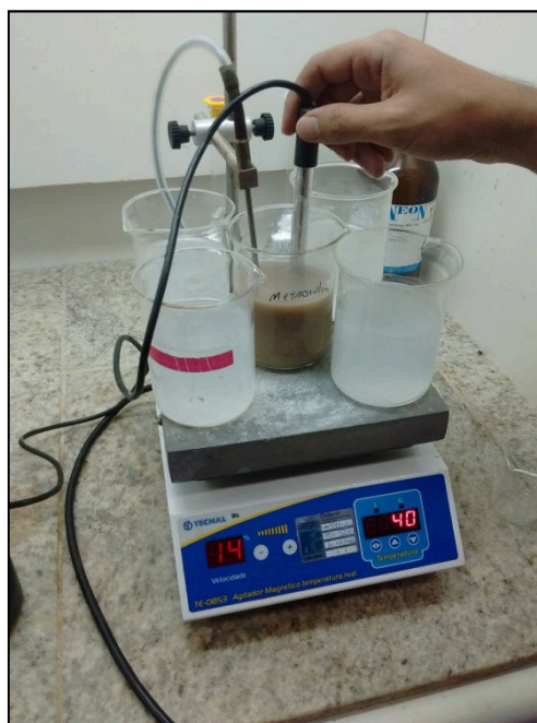
Figura 34: Ensaio de pozolanicidade pelo método de Luxán
