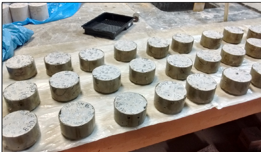
Figura 48: Corpos de prova com as laterais seladas
