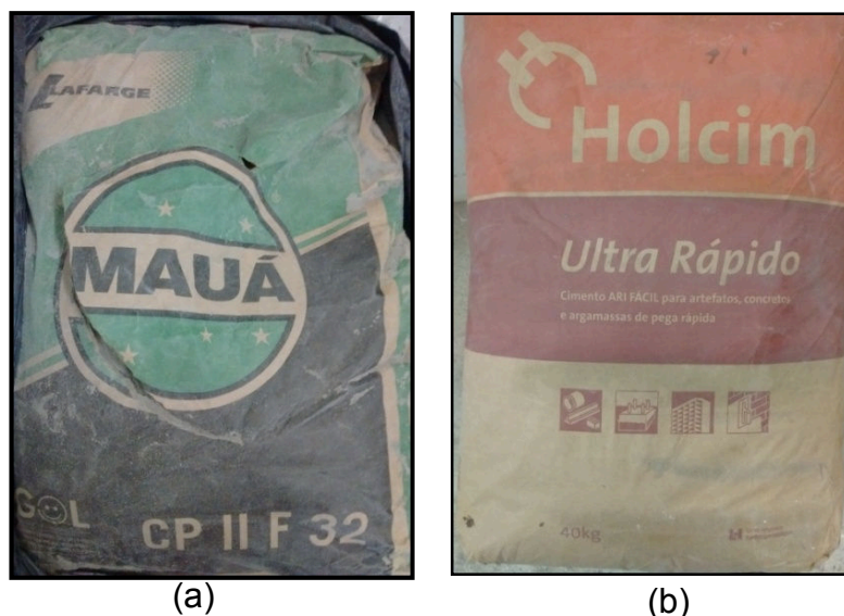
Figura 21 – Cimentos utilizados na pesquisa (a) determinação do IAP (b) confecção dos concretos
