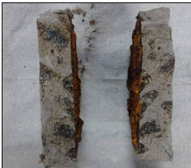
Figura 46: Corpo de prova após aspersão de nitrato de prata
