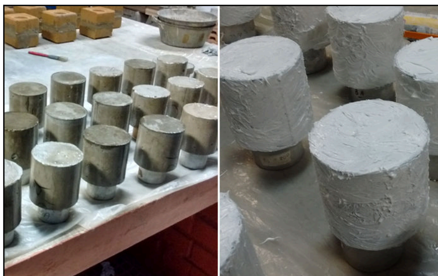
Figura 52: Corpos de prova impermeabilizados
