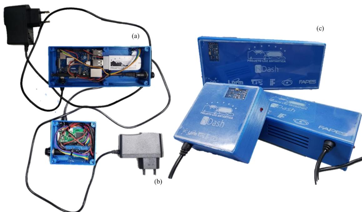
Figura 46 – Imagens do Gateway versão 1.0. (a) versão com modem aberta, (b) versão sem modem aberta, (c) conjunto de e protótipos finalizados, enviados para teste na EACF.
