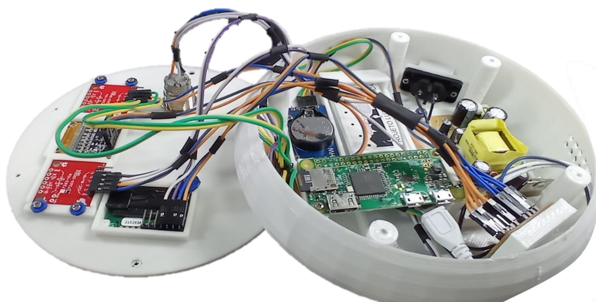
Figura 52 – Gateway na versão final, com as conexões montadas.
