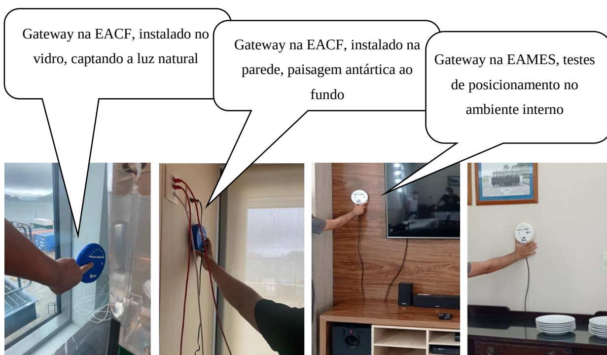
Figura 79 - Teste posicionamento dos Gateways nos dois estudos de caso (EACF e EAMES)
