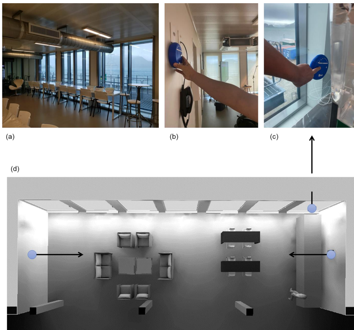
Figura 23 – Imagens da EACF: (a) sala de estar e refeições; (b) equipamento instalado na parede; (c) equipamento instalado na janela; e (d) desenho esquemático do posicionamento dos três equipamentos na sala de coleta dos dados ambientais, com as setas orientadas para a direção dos sensores espectrais. Fotos: Gabriel Prucoli Benevenuto (2021).
