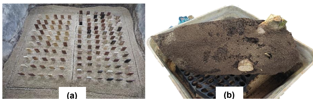
Figura 8. Preferência alimentar com térmitas subterrâneas. Distribuição dos tratamentos em DBC (a) e colônia térmita subterrânea disposta sobre os corpos de prova apoiada sobre uma estrutura de plástico (b).
