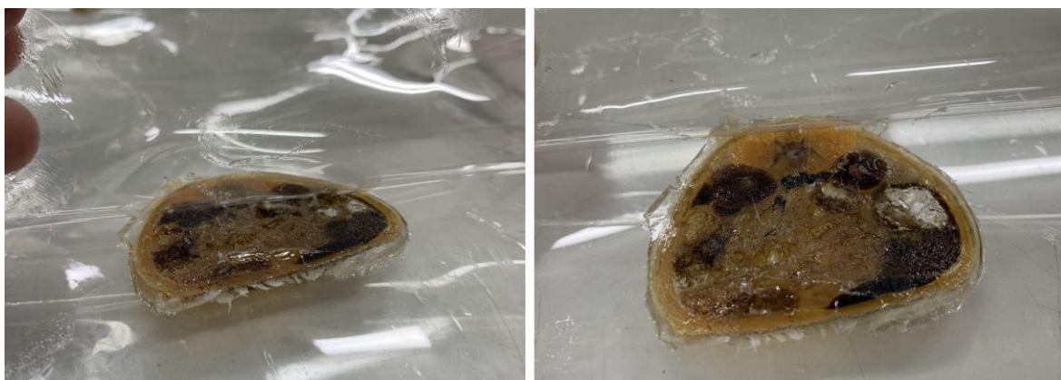
Figura 16. Etapa de desmontagem do sanduíche de cura do 1º teste com a resina de comercialização nacional, evidenciando a adesão de epóxi não curado nas folhas de acetato.
