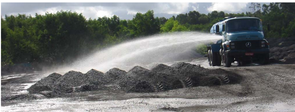
Figura 3.3 - Molhagem da escória de aciaria LD do estudo durante o tratamento utilizado
