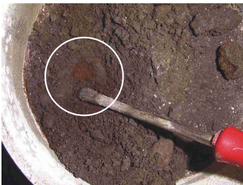
Figura 4.22 - Material que pode ter causado a expansão excessiva do corpo-de-prova 17 (CP 17) durante o ensaio de expansão da amostra tratada 1 pelo método PTM-130/78, energia do Proctor normal
