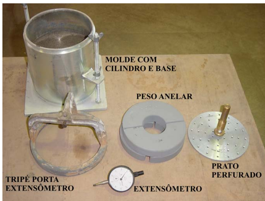
Figura 3.17 - Aparelhagem necessária para se fazer a leitura da expansão
