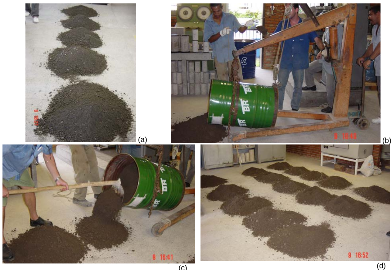
Figura 3.13 - Redução da amostra de campo na UFES: (a) cinco montes de escória de aciaria LD por tonel; (b) retirada da escória do tonel com guincho; (c) retirada da escória com enxada; (d) divisão dos três tonéis em quinze pilhas
