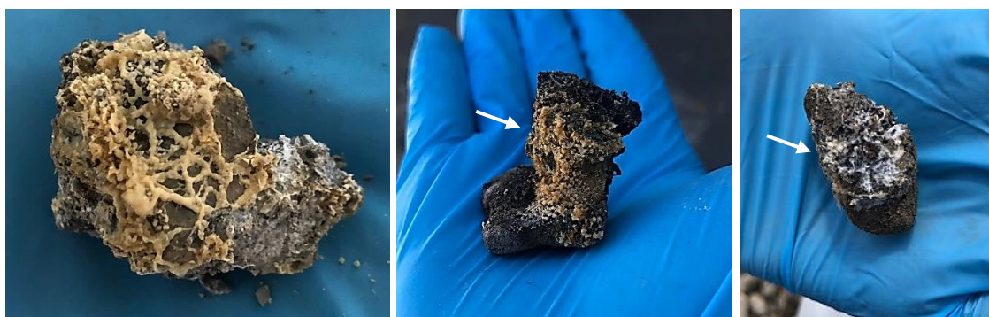
Figura 4.18: Evidência da formação de cristais no meio granular do FRE.
