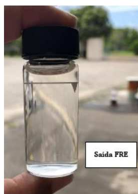
Figura 3.51: Turbidez da saída do FRE após 2 meses de operação. Fonte: Autoria própria.
