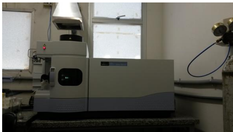
FIGURA 11 - ICP OES (Optima 7000, Perkin Elmer®) utilizado para as análises de metais em cachaça.
