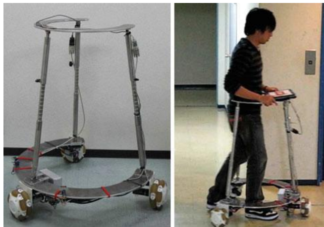
Figura 11: Protótipo do JARoW . Fonte: (LEE; OHNUMA; CHONG, 2010).
