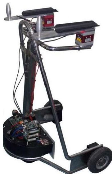
Figura 14: UFES' Smart Walker . Fonte: (CIFUENTES et al., 2014).
