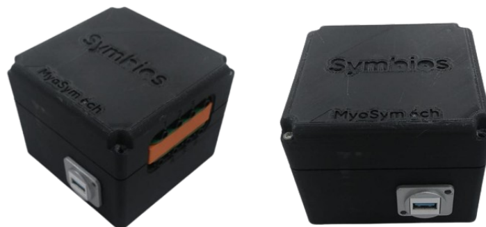
Figura 18 – Equipamento MyoSym (Symbios, Vitória, Brasil) para coleta de sinais de sEMG
