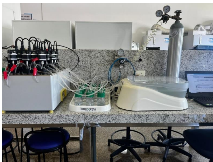
Figura 11 - Sistema Automático de Teste de Potencial de Biometano II (AMPTS II) utilizado na digestão anaeróbia de resíduo alimentar e inóculo após precipitação de estruvita Fonte: Autoria própria
