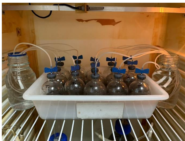
Figura 12 – Garrafas de sacrifícios na incubadora à 37°C utilizadas para monitoramento de pH, alcalinidade total, NAT e \text{NH}_3 .
