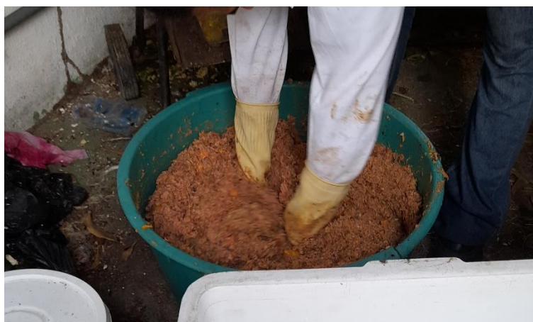
Figura 5 - Homogeneização das amostras simples coletadas em três dias consecutivos após o processamento no triturador. Fonte: Autoria própria.
