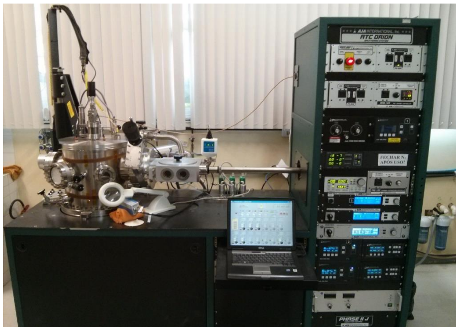
Figura 18 - Magnetron sputtering modelo ATC ORION da empresa AJA International utilizado no Lemag.
