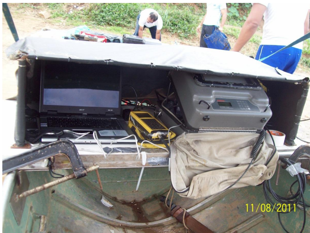
FIGURA 13 – Equipamentos utilizados para o levantamento batimétrico.
