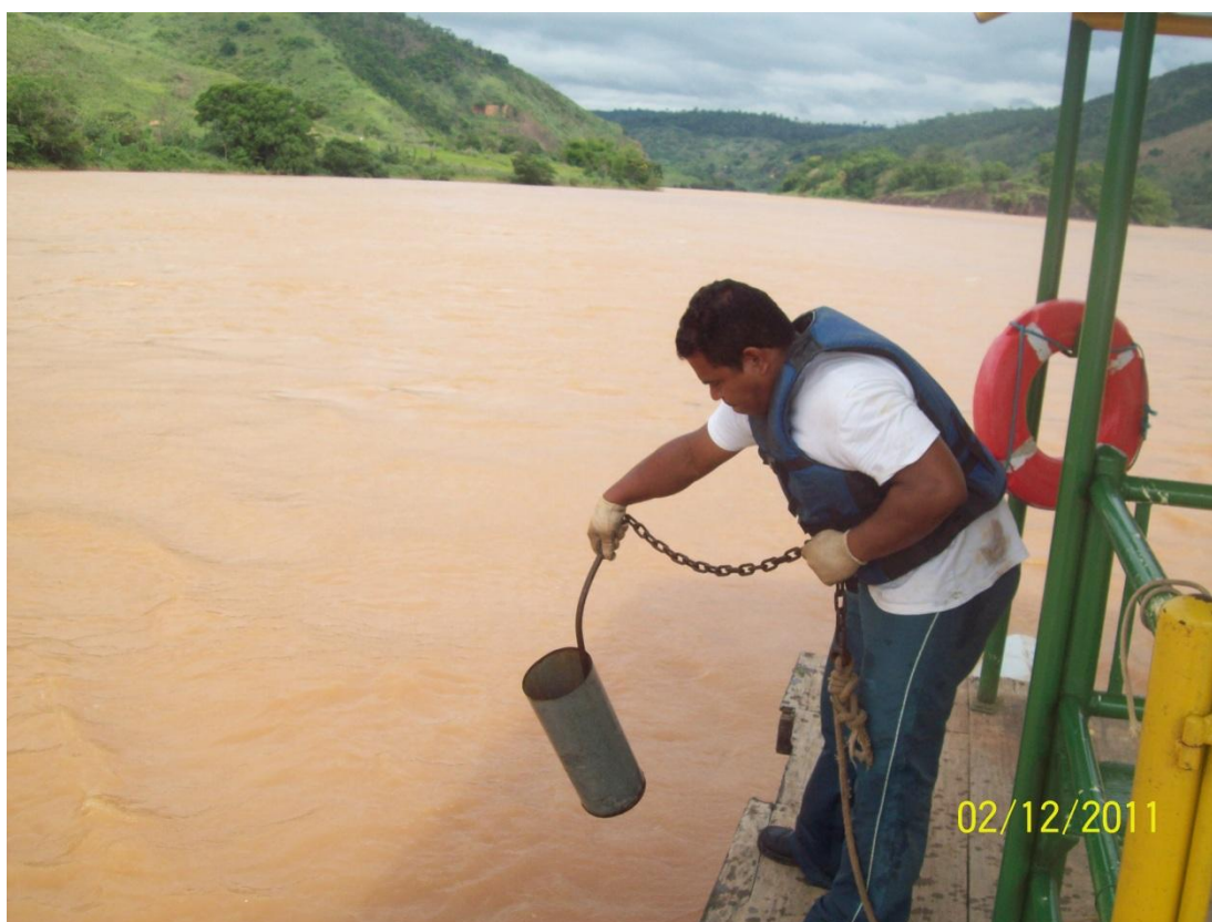
FIGURA 14 – Amostrador de material do leito o tipo Rock-Island.
