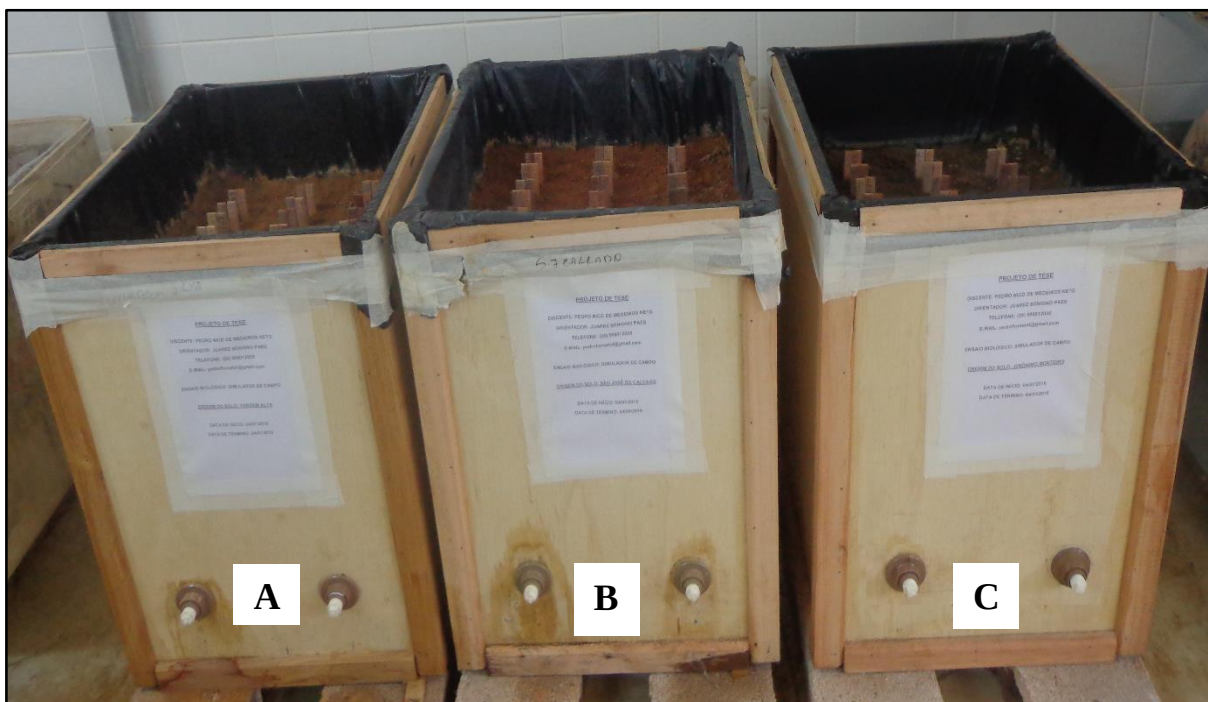
Figura 6 - Ensaio em simuladores de campo com as sete espécies de eucaliptos e solos dos locais avaliados. A: Vargem alta, B: São José do Calçado e C: Jerônimo Monteiro.
