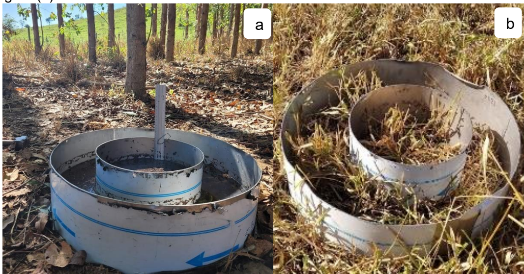
Figura 4 – Infiltrômetro de anéis utilizado em ensaios de infiltração em área de eucalipto (a) e pastagem (b).
