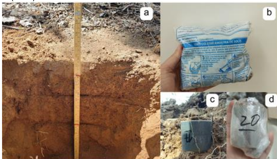
Figura 5 – Coletas de solo por meio de trincheiras (a); armazenamento de amostra deformada em sacola plástica (b); retirada e armazenamento de amostra indeformada em anel volumétrico (c e d).
