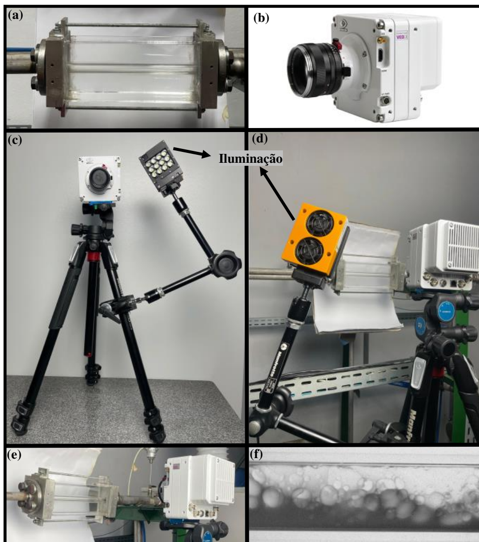
Figura 16 – Trecho de visualização e aparato para realização das fotos dos padrões de escoamento.
