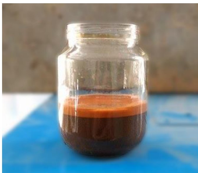
Figura 23 - Camada de água superficial quando amostra de menor concentração é deixada em repouso
