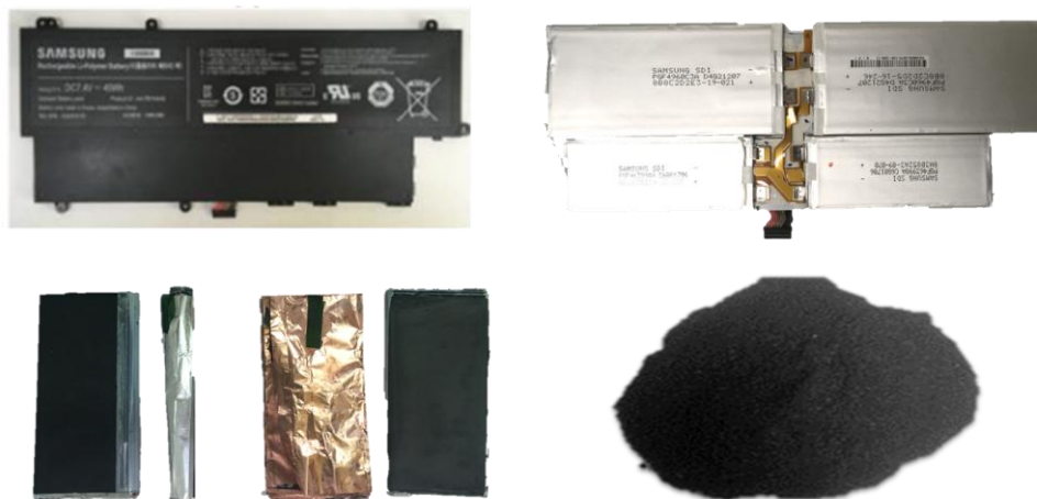
Figura 9: Etapas do pré-tratamento da amostra de bateria de íon-Li polímero para obtenção do pó do material ativo do cátodo.
