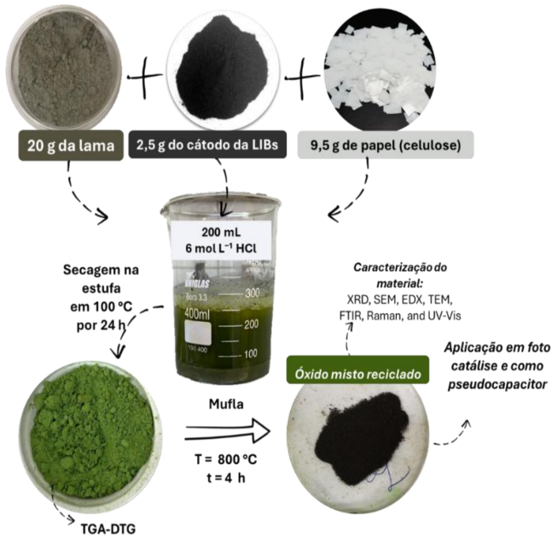
Figura 10: Esquema da síntese da \text{CoFe}_2\text{O}_4/\gamma\text{-Fe}_2\text{O}_3@\text{SiO}_2/\text{NaAlSi}_3\text{O}_8 .
