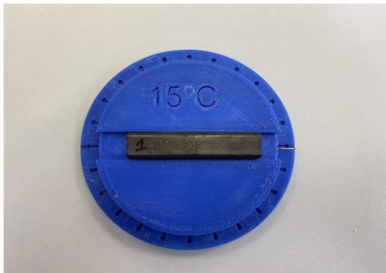
Figura 18 – Suporte com variação de 15° para os ensaios magnéticos
