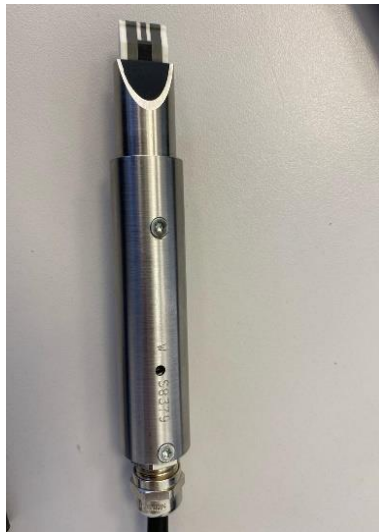
Figura 17 – Sensor utilizado para o ensaio no equipamento Rollscan 350
