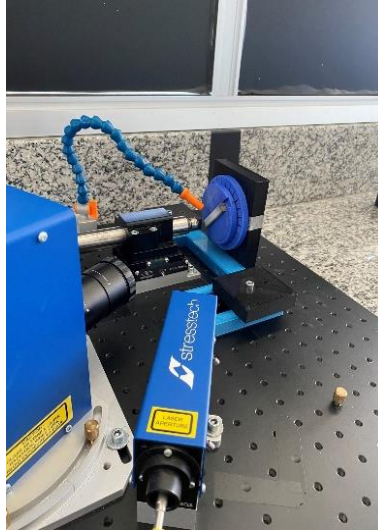
Figura 19 – Equipamento Prims da Stresstech, utilizado para o ensaio de Furo Cego
