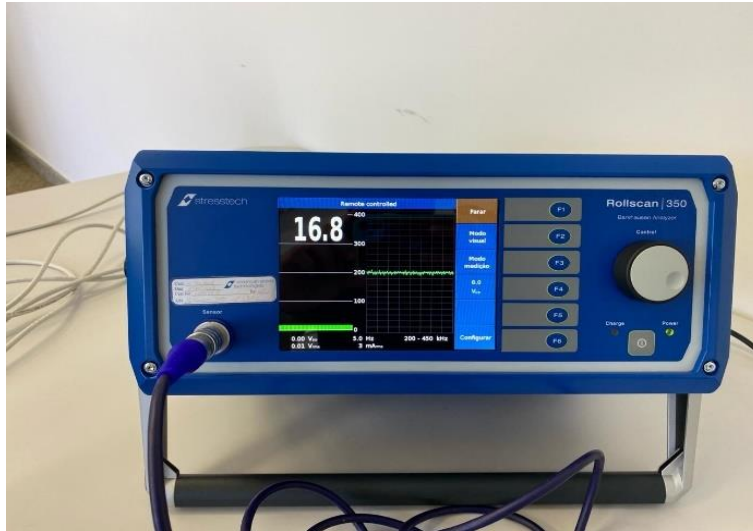
Figura 16 – Equipamento Rollscan 350, utilizado para os ensaios
