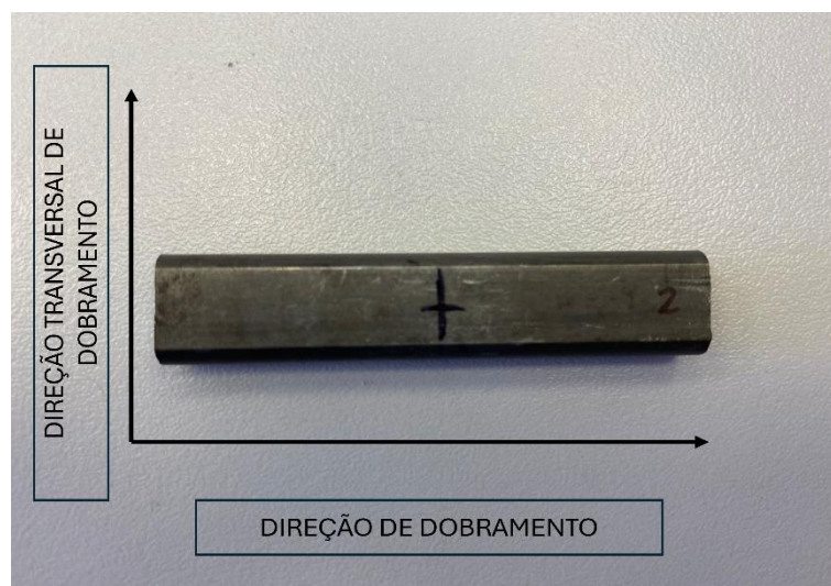
Figura 15 – Representação das direções de análise da amostra
