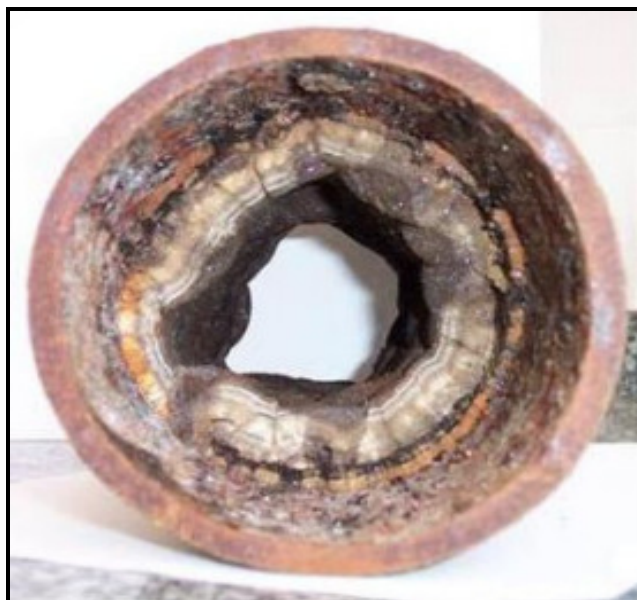
Figura 5. Depósitos de sais em coluna de produção de petróleo (TEIXEIRA, 2007).
