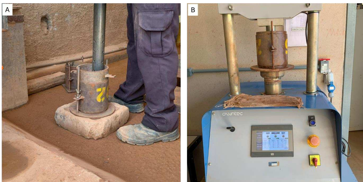
Figura 19 - Ensaio de Compactação (A) e ISC (B)
