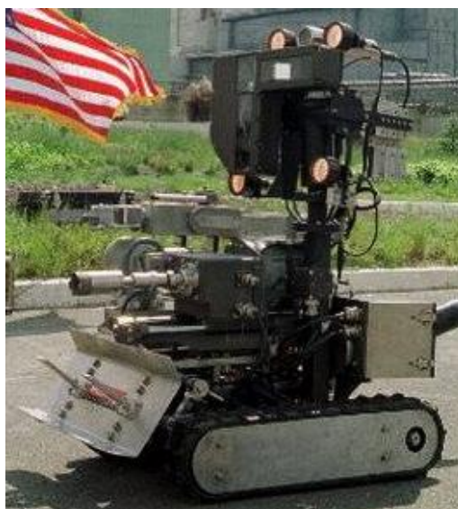
Figura 2.3: Exemplo de robôs com esteiras (NOURBAKHS e SIEGWART, 2004).
