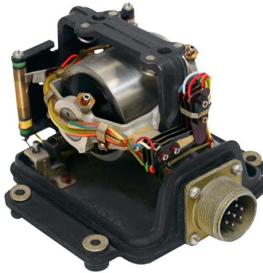
Figura 2.11: Giroscópio mecânico de massa girante desencapsulado.
