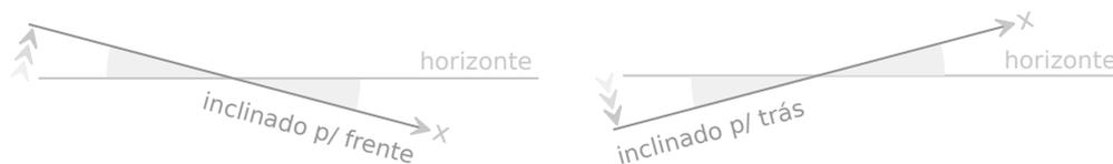
Figura 4.4: Movimento oscilatório equivalente a empurar as extremidades do quadrotor para cima e para baixo.
