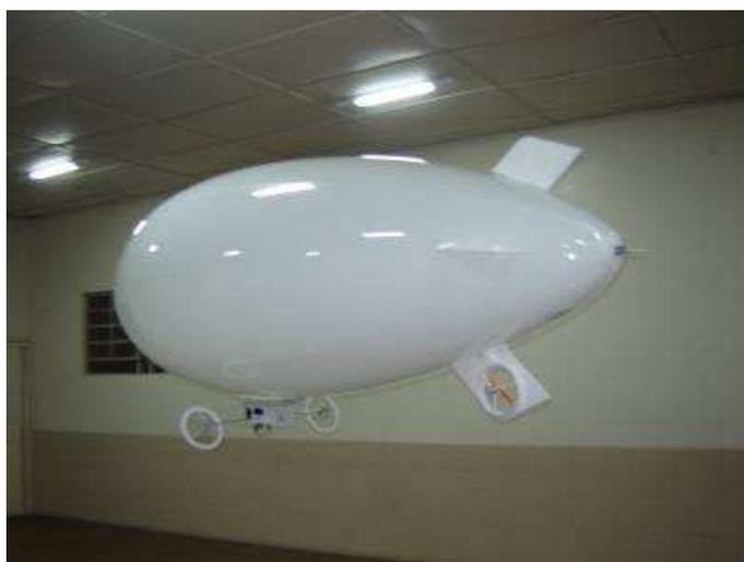
Figura 1.3: Dirigível elétrico voando *indoor*.
