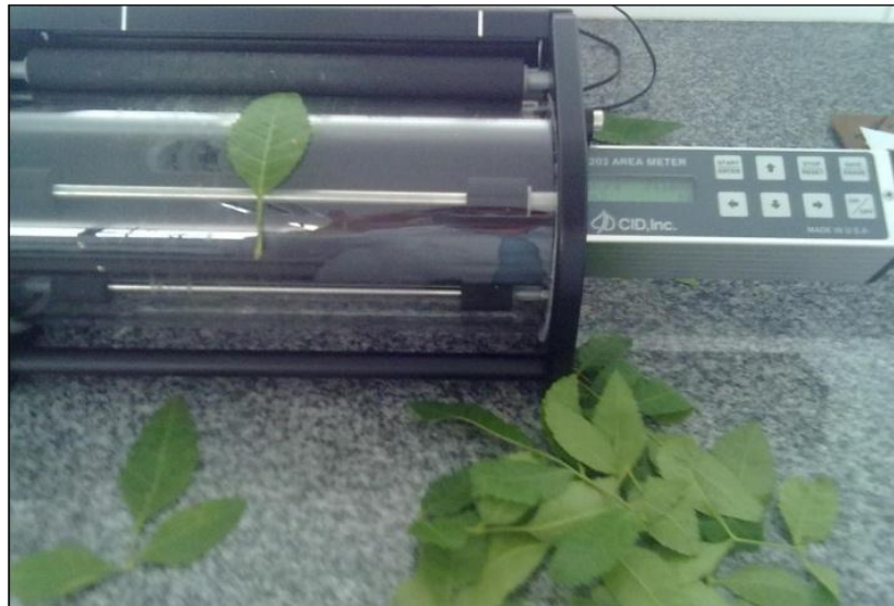
FIGURA 12. Determinação da área foliar com processador de imagem digital.
