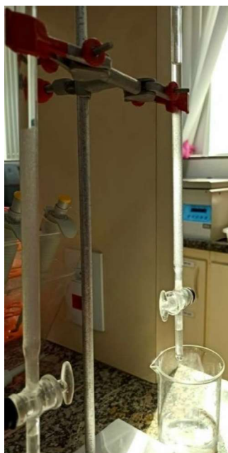
Figura 18. Coluna de vidro preenchida com a massa da resina Chelex-100® para realização do procedimento de pré-concentração dos analitos presentes nas amostras de água do mar.
