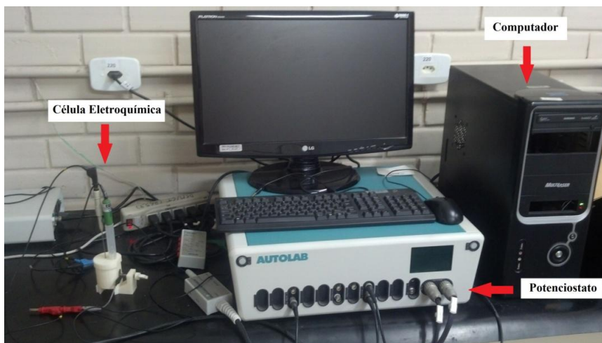
Figura 4.6 – Célula eletroquímica, potenciostato e computador.
