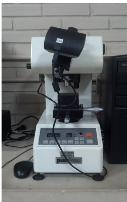
Figura 4.5 – Microdurômetro Pantech HXD-1000TM
