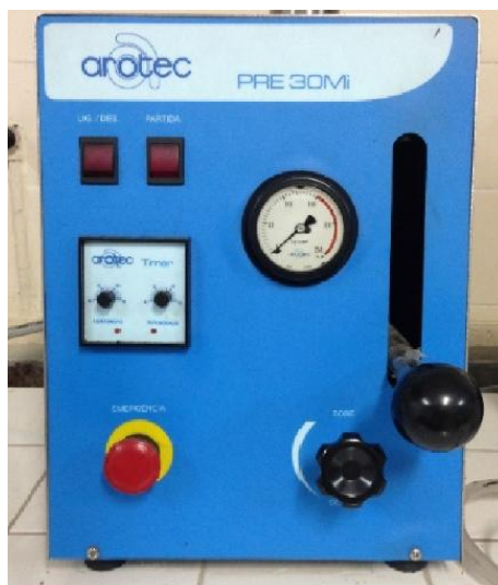
Figura 4.2 - Embutidora PRE 30Mi Arotech.
