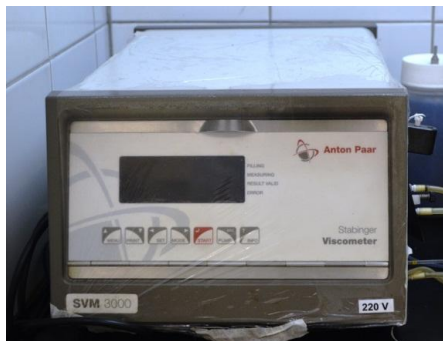
Figura 4.2. Viscosímetro Stabinger SVM 3000 fabricado pela Anton Paar. Fonte: Laboratório de Caracterização e Processamento Primário – LABPETRO/ NCQP (UFES).
