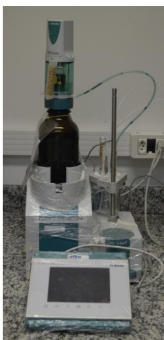
Figura 4.3. Titulador automático, modelo 836 Titrande, fabricado pela Metrohm. Fonte: Laboratório de Caracterização e Processamento Primário – LABPETRO/ NCQP (UFES).
