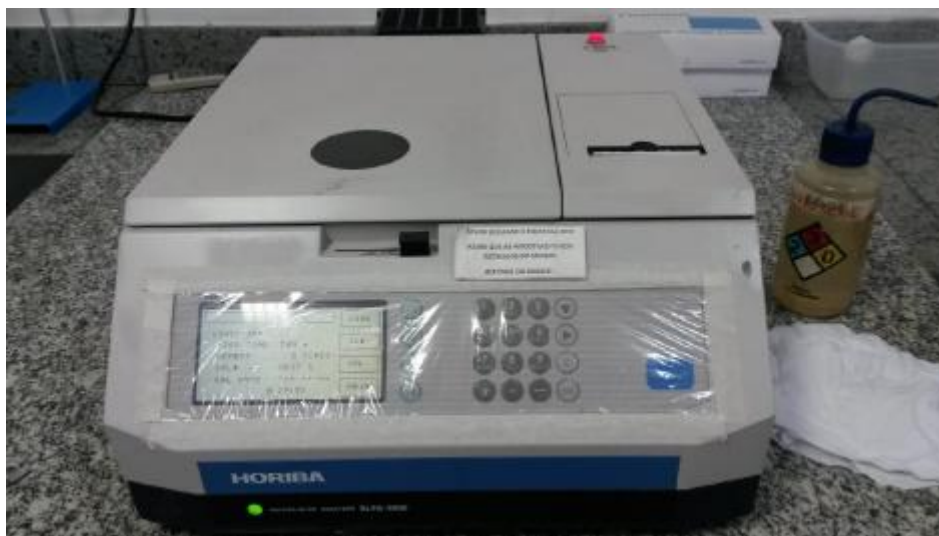
Figura 4.4. Analisador de enxofre automático fabricante HORIBA modelo SFLA-2800. Fonte: Laboratório de Caracterização e Processamento Primário – LABPETRO/ NCQP (UFES).
