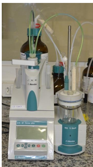
Figura 4.1. Titulador Karl Fischer Metrohm (modelo 870 KF titrino plus). Fonte: Laboratório de Caracterização e Processamento Primário – LABPETRO/ NCQP (UFES).
