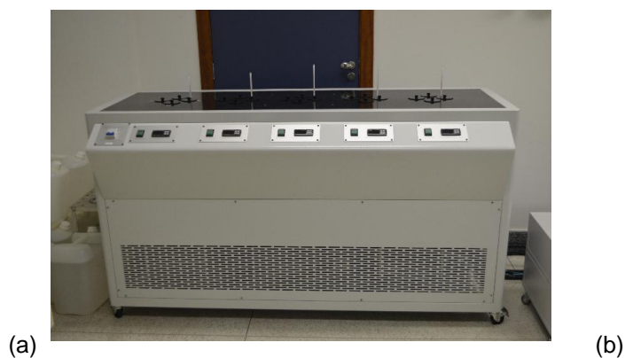
Figura 4.6. (a) Equipamento semiautomático do fabricante PETROTEST, modelo 531/S (b) frasco teste para análise de ponto de fluidez. Fonte: Laboratório de Caracterização e Processamento Primário – LABPETRO/ NCQP (UFES).
