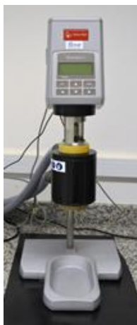
Figura 4.5. Reômetro rotacional Anton Paar, modelo RheolabQC. Fonte: Laboratório de Caracterização e Processamento Primário – LABPETRO/ NCQP (UFES).
