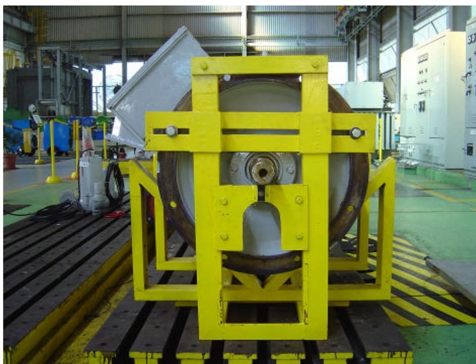
Figura 14 - dispositivos de travamento de rotores para ensaio de rotor bloqueado
