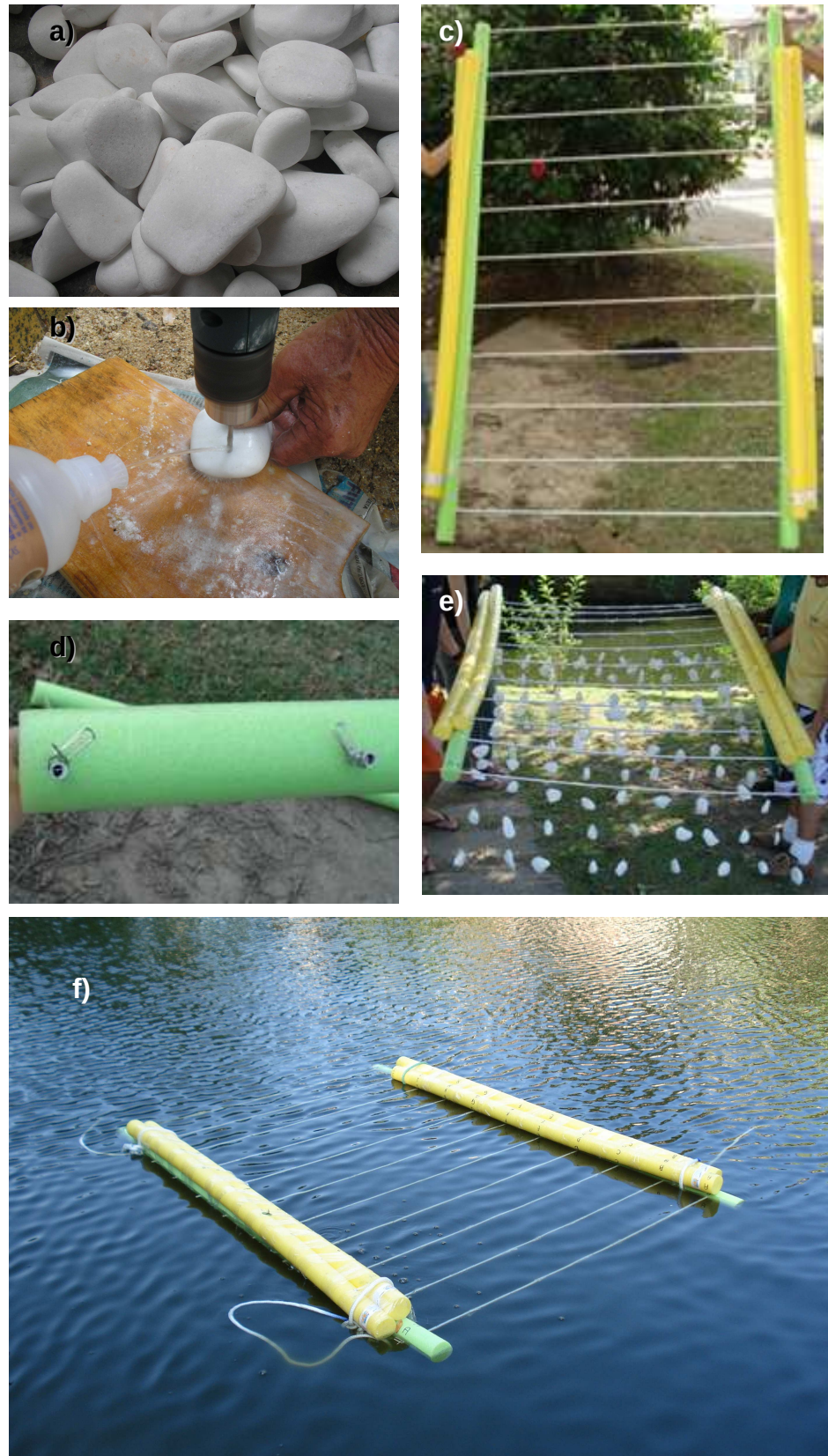
Figura 4: Montagem e instalação do experimento. a) substrato artificial rochoso; b) substrato sendo furado; c) bóias “macarrão” amarradas entre si e ligadas por barras de alumínio; d) clips metálicos prendendo as barras de alumínio às bóias macarrão; e) estrutura experimental montada; f) implantação do experimento na água.
