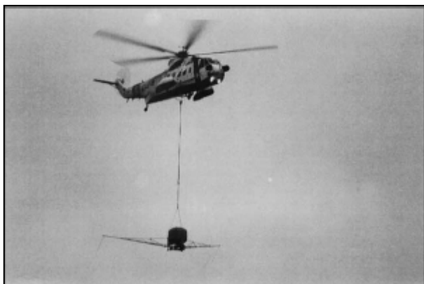
Figura 14 (A) – Operação de Dispersão Química utilizando Helicóptero ( Sikorsky S-61 )
