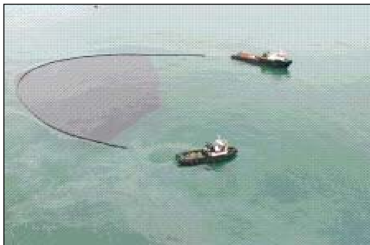
Figura 6 – Operação de Contenção de Óleo no Mar, com Formação em “U”
