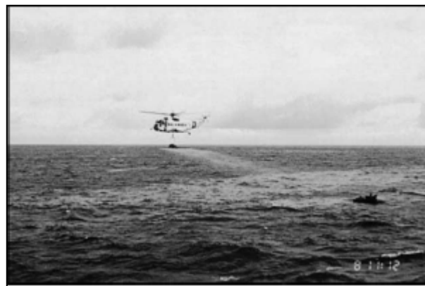
Figura 14 (A) – Operação de Dispersão Química utilizando Helicóptero ( Sikorsky S-61 )
