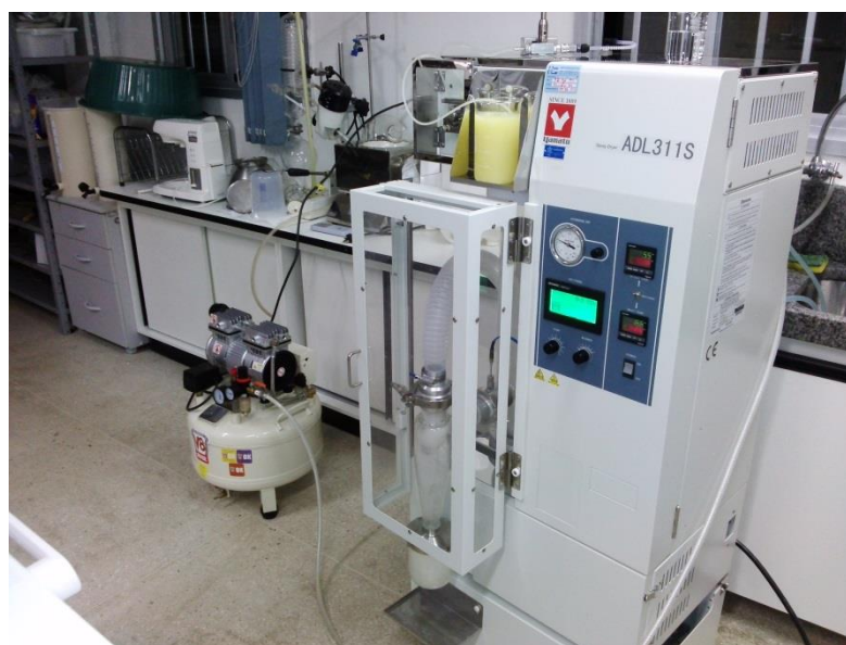
Figura 4 – Conjunto compressor e atomizador (spray-dryer) utilizado no processo de secagem. Fonte: O autor (2015).
