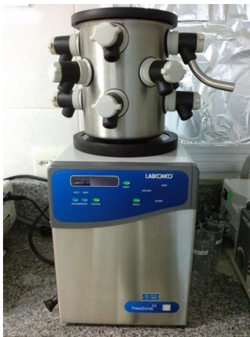
Figura 3 – Liofilizador de bancada utilizado no processo de secagem. Fonte: O autor (2015).
