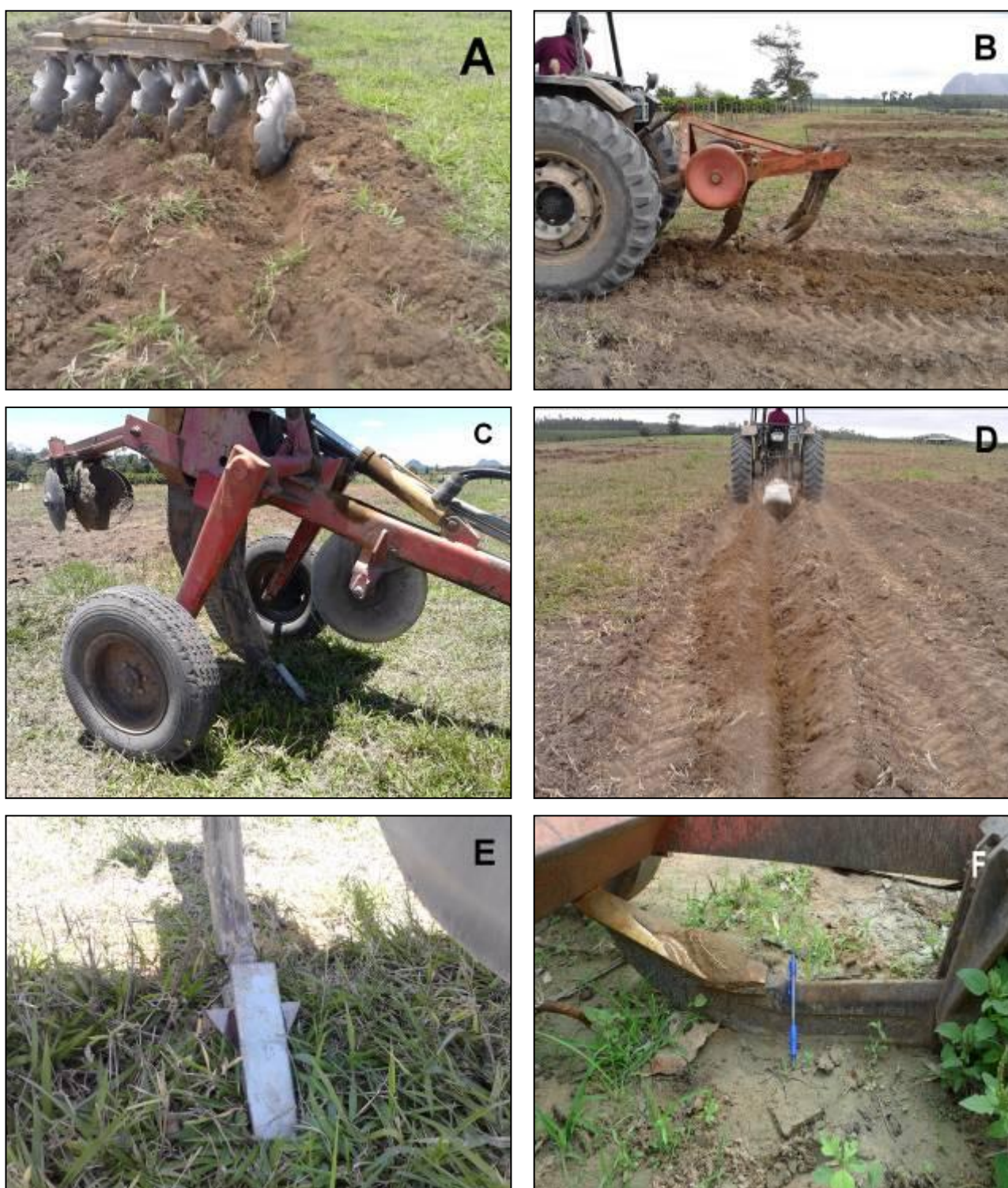
Figura 3. Preparo do solo com grade aradora (A); preparo com escarificador (B); subsolador utilizado (C); sulcamento utilizado em todos os tratamentos (D); detalhe da ponteira do subsolador (E); detalhe da ponteira do escarificador (F).
