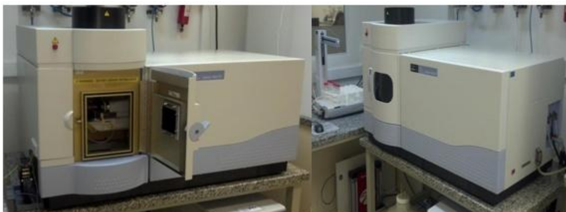
Figura 10. Espectrômetro de emissão óptica com plasma indutivamente acoplado, modelo Optima 7000 DV (PerkinElmer, EUA).
