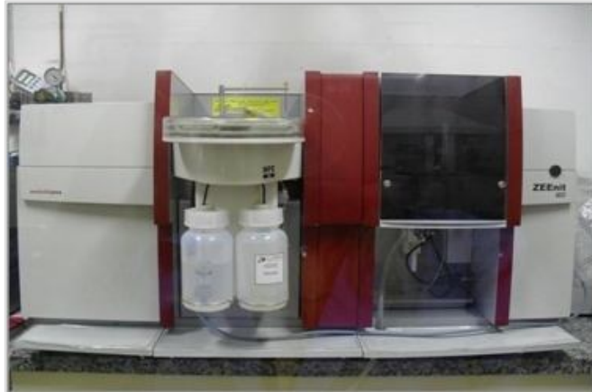
Figura 5. Espectrômetro de absorção atômica em forno de grafite ZEE nit 700 (Analytik Jena), com acessório de líquidos MPE 60.
