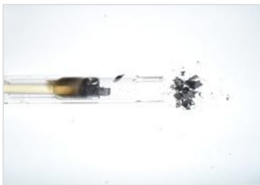
Figura 8. Tocha do ICP OES com formação de depósito de carbono
