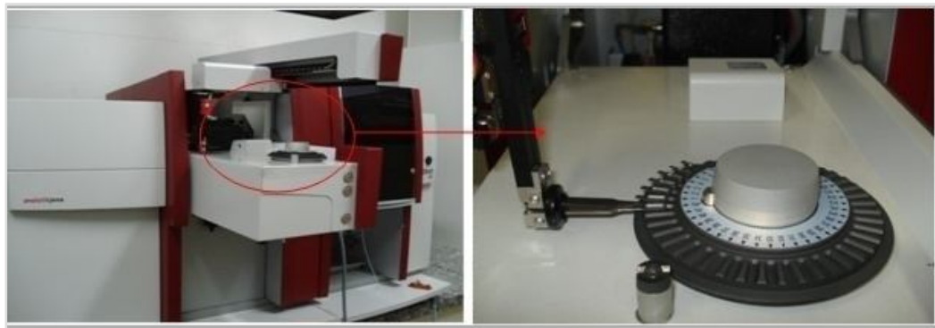
Figura 6. Espectrômetro de absorção atômica em forno de grafite ZEE nit 700 (Analytik Jena), com acessório de amostragem direta SSA 600.
