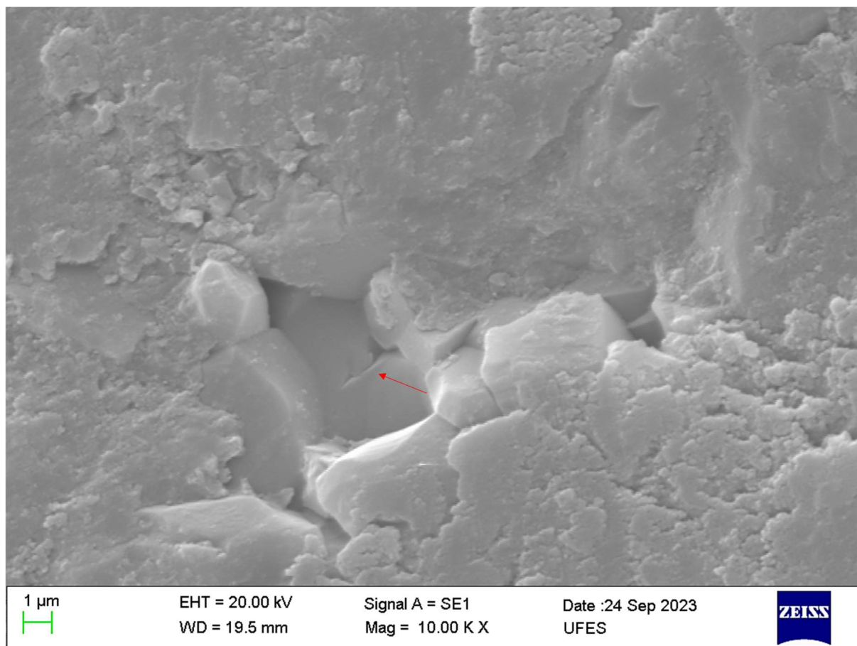
Figura 83. MEV – Trincamento intergranular e possível Flake formation na MC_AL99. Fonte: autor.
