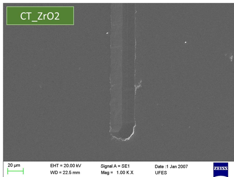
Figura 66. Deformação plástica na zircônia mesmo nas maiores cargas com indentador Vickers.
