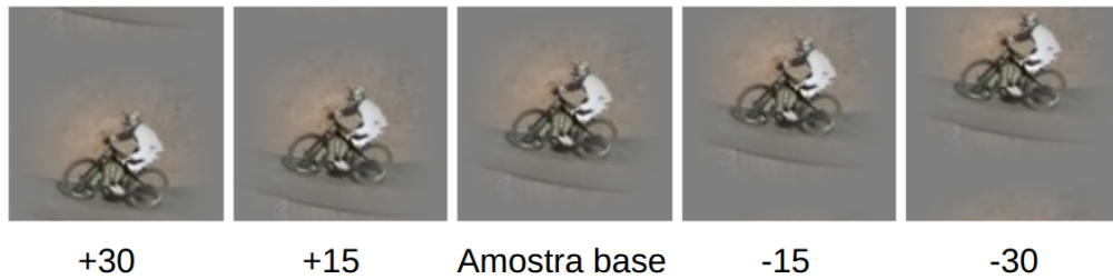
Figura 17 – Deslocamento cíclico vertical de uma imagem base. O KCF aplica o deslocamento vertical e horizontal para todas possíveis variações da imagem de referência ( patches ).
