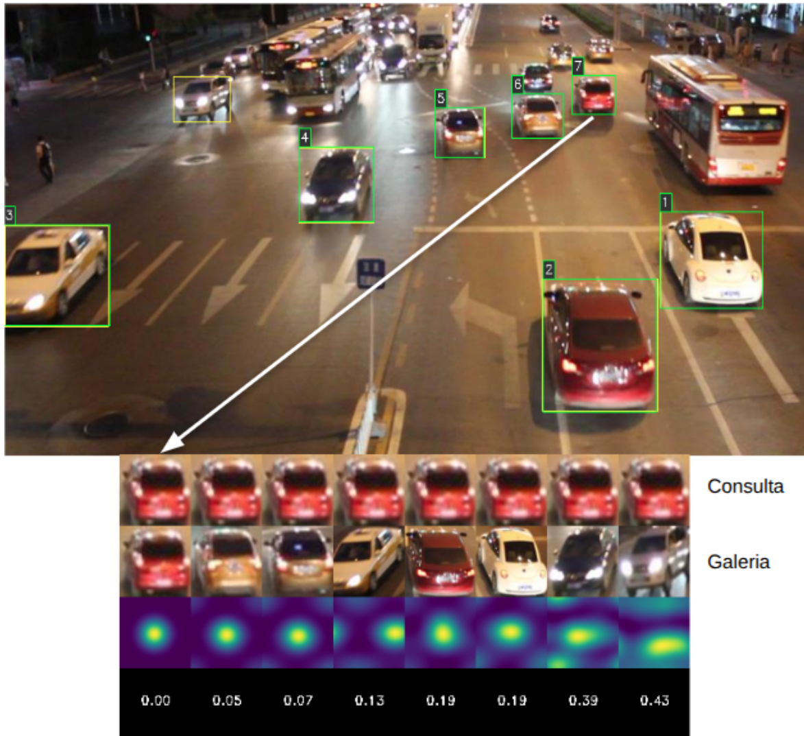
Figura 36 – Reidentificação com DCF no ByteTrack por fusão ( Fuse ReID ).
