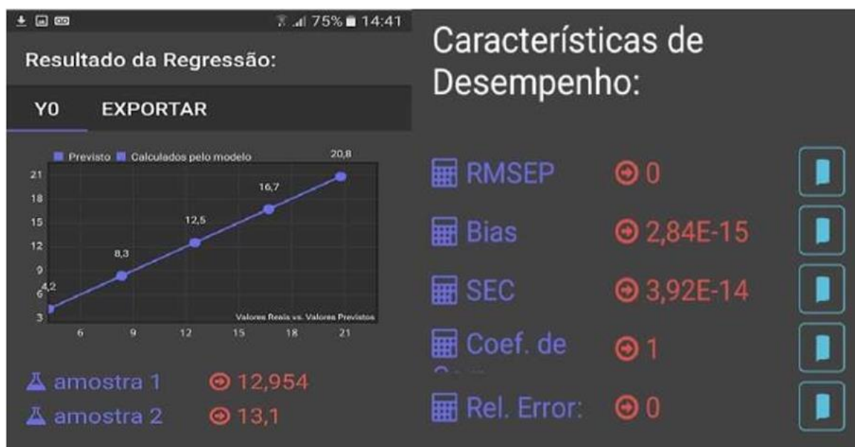
Figura 37. Reta de regressão linear gerada pelo aplicativo com os valores reais versus valores previstos, evidenciando a previsão da concentração das duas amostras junto aos parâmetros de desempenho gerados pelo segundo grupo.
