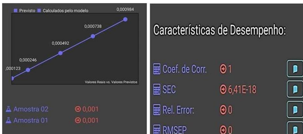
Figura 31. Reta de regressão linear gerada pelo aplicativo, mostrando valores reais versus valores previstos e evidenciando a previsão da concentração de duas amostras, junto aos parâmetros de desempenho do modelo.
