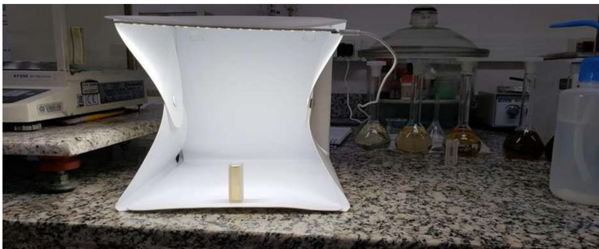
Figura 21. Sistema montado para tomada de fotos das amostras da resina.
