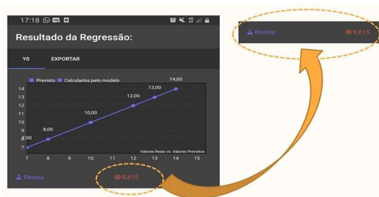
Figura 86. Valor encontrado pelo REDGIM® para a amostra de resina com o indicador azul de bromotimol.
