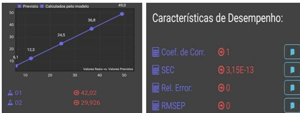
Figura 34. Reta de regressão linear gerada pelo aplicativo com os valores reais versus valores previstos, evidenciando a previsão da concentração das duas amostras junto aos parâmetros de desempenho gerados pelo modelo da segunda tentativa.
