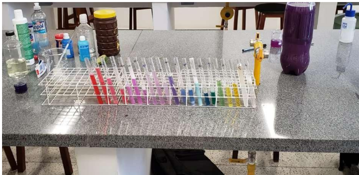
Figura 63. Construção da escala de pH com os produtos do cotidiano usando indicador de repolho roxo.
