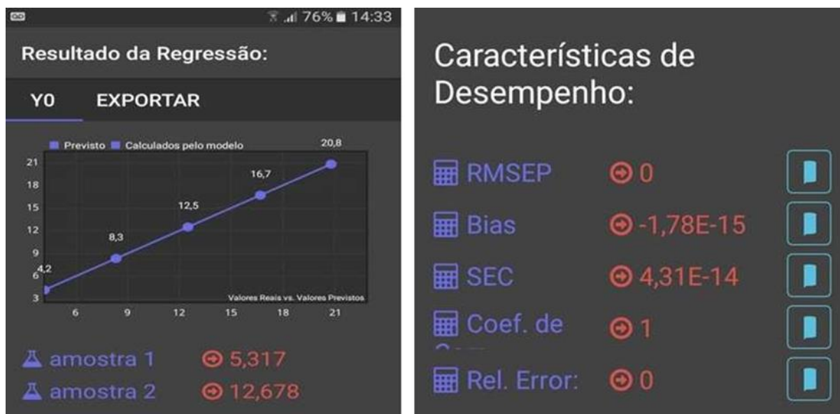
Figura 40. Reta analítica gerada pelo aplicativo com os valores reais x valores previstos, evidenciando a previsão das duas amostras e desempenho do modelo de regressão dos alunos do segundo grupo relativo ao suco de pêssego.
