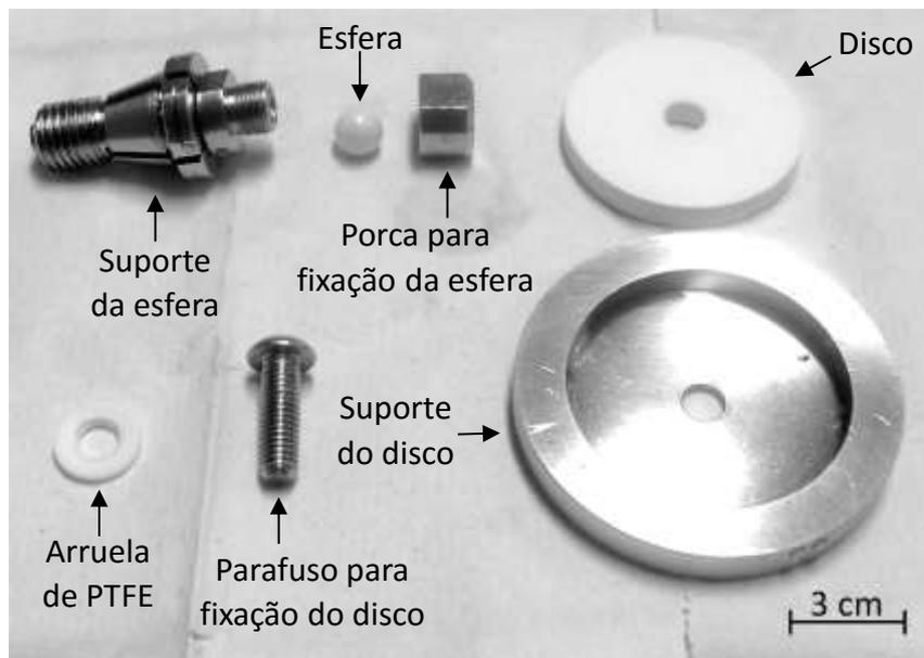
Figura 30 - Amostras e componentes usados para fixá-las ao tribômetro. Fonte: autor.
