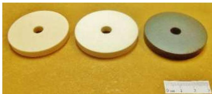
Figura 23 - Aspecto macroscópico de discos de  $\text{Al}_2\text{O}_3$  (à esquerda), ZTA (centro) e  $\text{SiC}$  (à direita). Fonte: autor.
