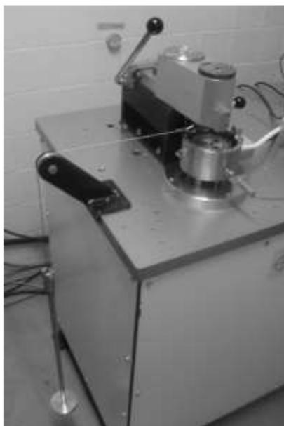
Figura 35 - Sistema de calibração da célula de carga que mede a força de atrito. Fonte: autor.
