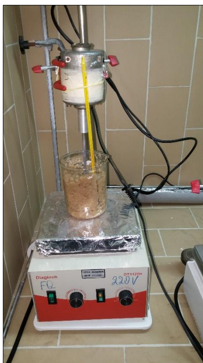
Figura 24. Tratamento da FNB com o surfactante CTAB.
