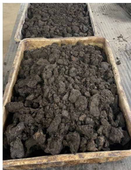
Figura 36 – Solo natural preparado para ir à estufa à 60°C.
