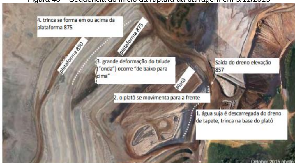
Figura 40 – Sequência do início da ruptura da barragem em 5/11/2015
