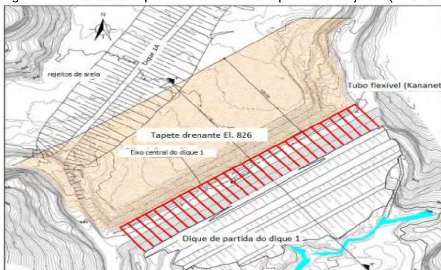
Figura 22 – Planta do Tapete drenante sobre superfície de rejeitos (El. 826 m)
