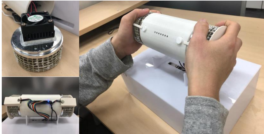
Figura 20 - Protótipo tátil que permite a variação da temperatura para complementar a interação com agentes inteligentes baseados em voz. Fonte: Kim et al. [42].
