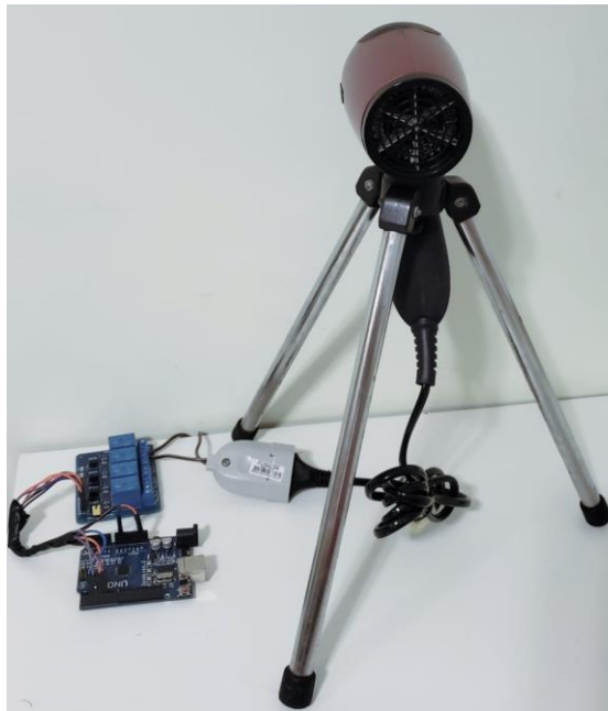
Figura 25 - Dispositivo de vento quente, com o módulo de relés conectado a um Arduino Uno (esquerda) e um secador (direita). Fonte: Elaborada pelo autor.
