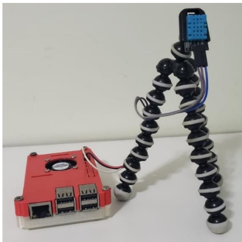
Figura 29 - Sensor para monitor a temperatura. No lado esquerdo, o Raspberry Pi 3; e, no lado direito, o sensor DHT11. Fonte: Elaborada pelo autor.
