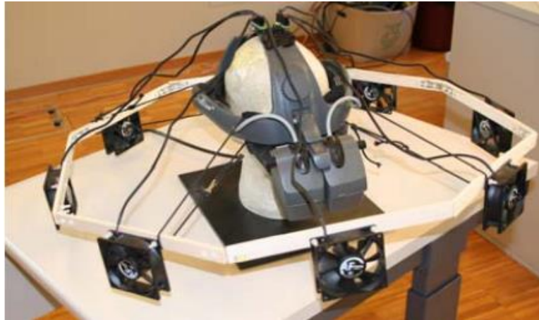
Figura 4 - Sistema desenvolvido para aumentar a imersão, através de ventos, dos pilotos em aeronaves operadas a distância. Fonte: Cardin et al. [5].
