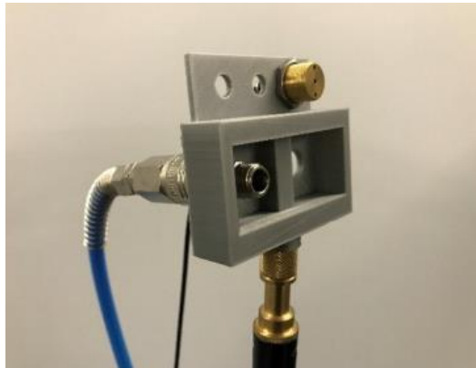
Figura 16 - Dispositivo criado para produzir estímulos táteis (ventos) e olfativos. Fonte: Narciso et al. [35].
