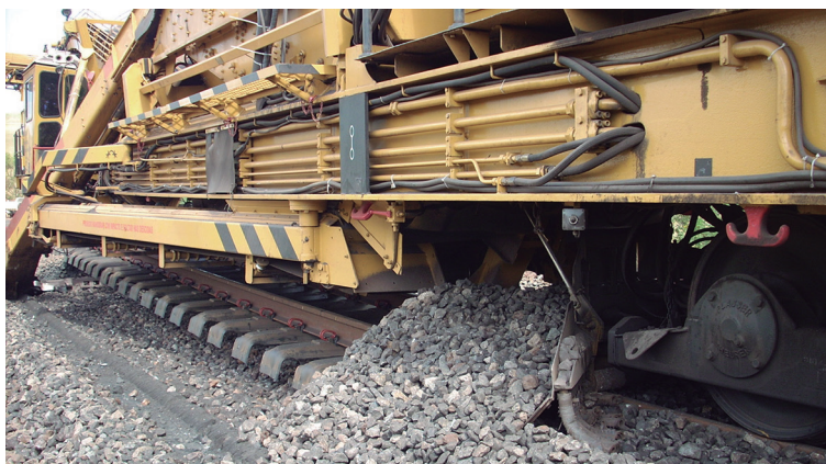
Figura 328 – Desguarnecedora de lastro repondo lastro após ter sido peneirado
