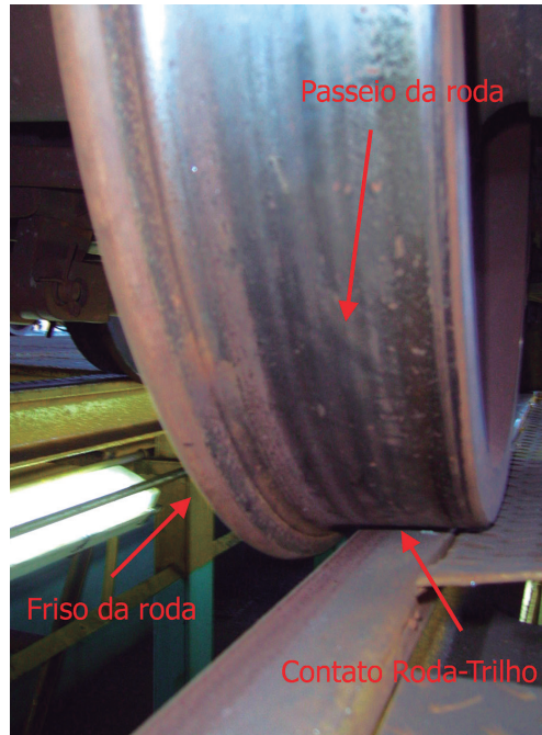
Figura 133 – Detalhe da roda sobre o bolete do trilho e detalhe do friso
