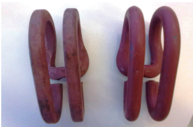
Figura 291 – Visão grampo Denick seção circular (mais recente) e seção retangular (mais antiga)
