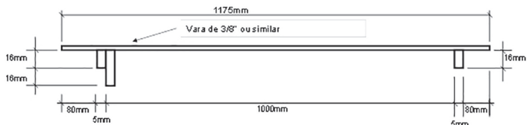
Figura 157 – Gabarito substituto da régua bitoladora
