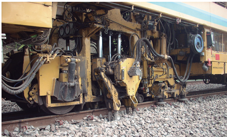
Figura 323 – Detalhe das patas de socaria (dentro do lastro) da socadora de lastro
