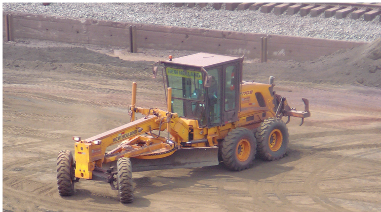
Figura 59 – Motoniveladora com escarificador
