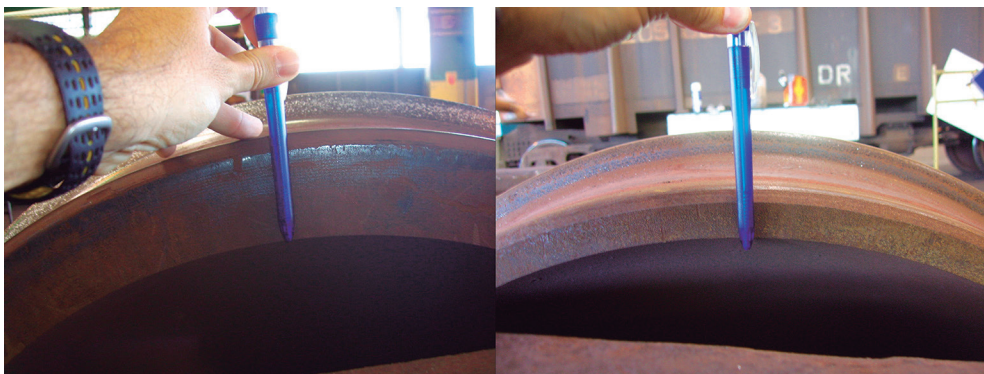
Figura 134 – Desgaste da bandagem da roda
