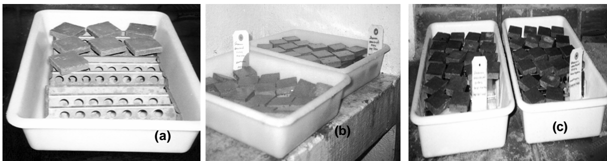
Figura 3.7: Procedimento de cura das amostras antes de serem carbonatadas. (a) distribuição na bandeja plástica, (b) cura em névoa e (c) conservação em ambiente de laboratório.
