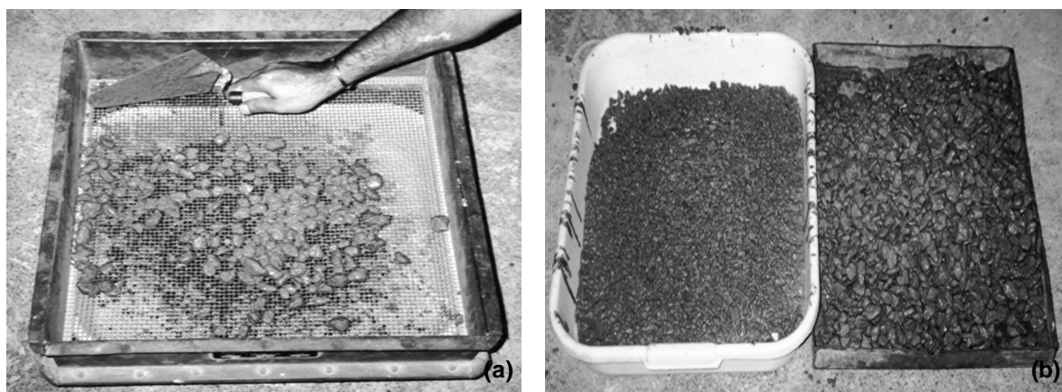
Figura 3.4: Obtenção da argamassa do concreto. (a) peneiramento, (b) argamassa e agregado graúdo
