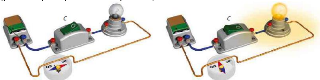
Figura 6 - Esquema para demonstração do experimento de Oersted.
