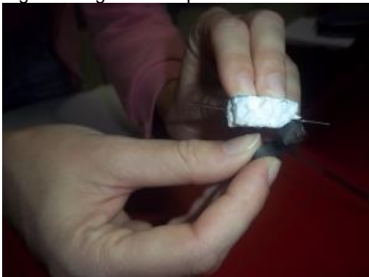
Figura 3: Agulha e isopor sendo friccionado no ímã.
